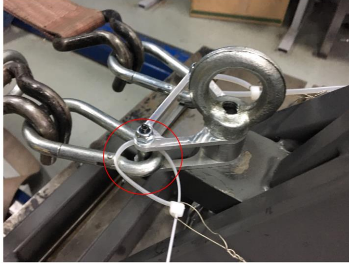
Şekil 4.15. Fiziksel yükleme testi kanca bağlantı sistemi
