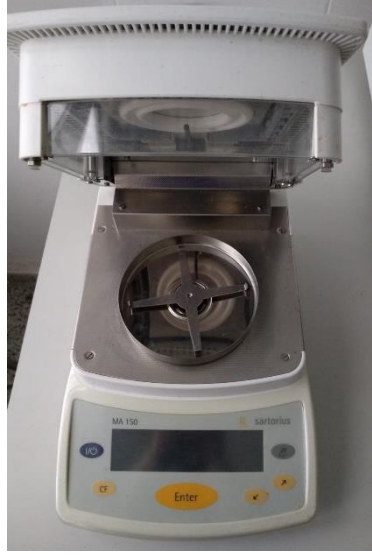
Şekil 3.2. Nem ölçüm cihazı (MA150 Sartorius, Göttingen)
