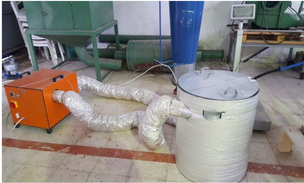
Şekil 3.3. Tüp içindeki gaz sıcaklığını sabit tutmak için kullanılan sıcak hava banyosu
