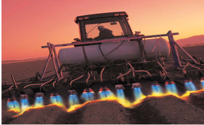
Şekil 2.1. Traktörle çekilir tip alev makinası (Red Dragon, 2019)
