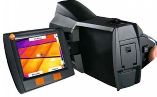
Şekil 3.5. Alev hüzmesinin izlenmesi için kullanılan termal kamera
