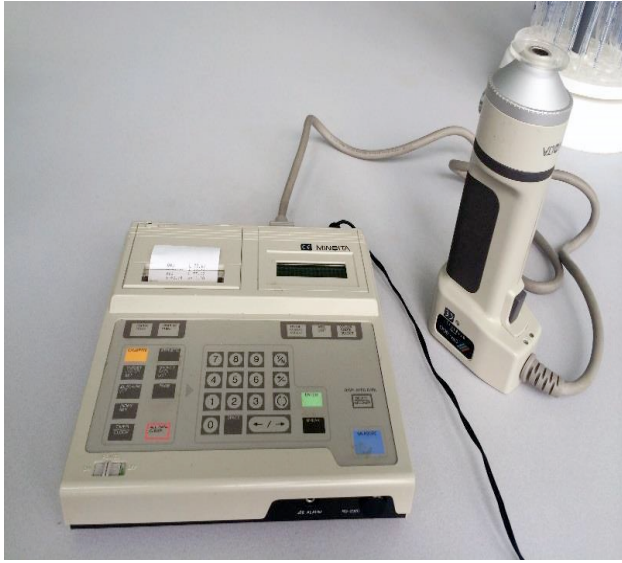
Şekil 3.10. Renk ölçümlerinin gerçekleştirildiği Minolta CR-300 renk okuma cihazı (Konica-Minolta, Osaka, Japon)
