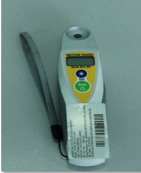
Şekil 3.12. SÇKM ölçümlerinde kullanılan dijital el refraktometresi
