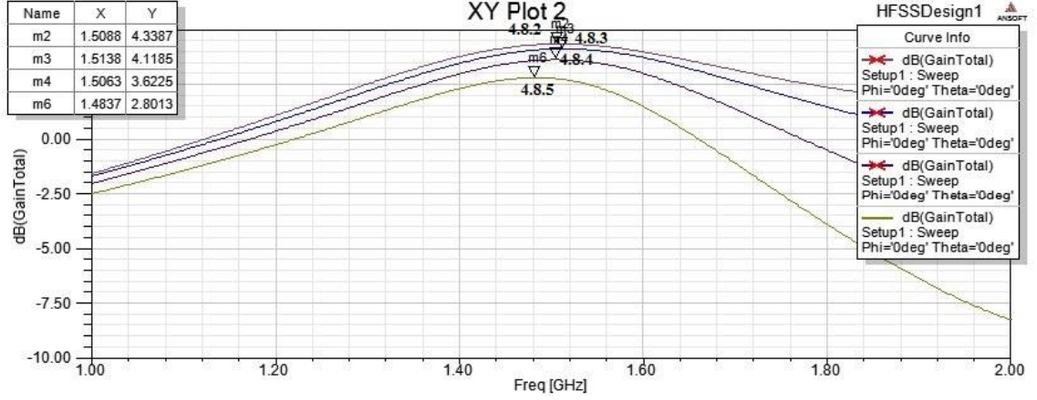
Şekil 4.14. 1,43-1,63 GHz aralığında r'ye Bağlı Kazanç Değişimi
