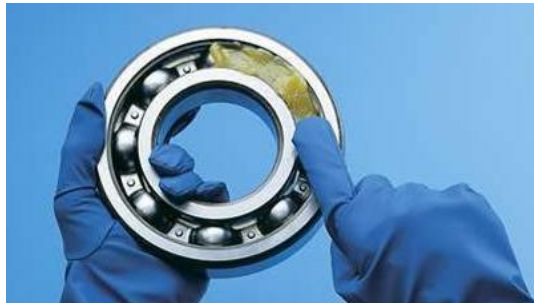
Şekil 2.4. Rulmanların yağlanması ( https://www.makinaegitimi.com/rulmanlarin-yaglanmasi/ )
