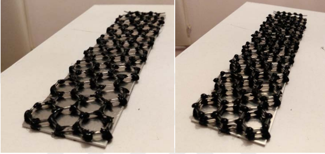
Şekil 3.36 İlk aşamada balpeteği kafes yapısı metal bir plakaya monte edilmiş ve diğer kafes yapı üzerine oturtulmuş hali.
