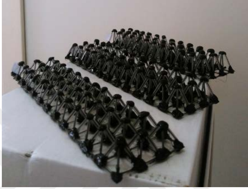
Şekil 3.34 B modeline ait sandviç çekirdeği için üç ayrı yükseklikte üretilen numune örnekleri
