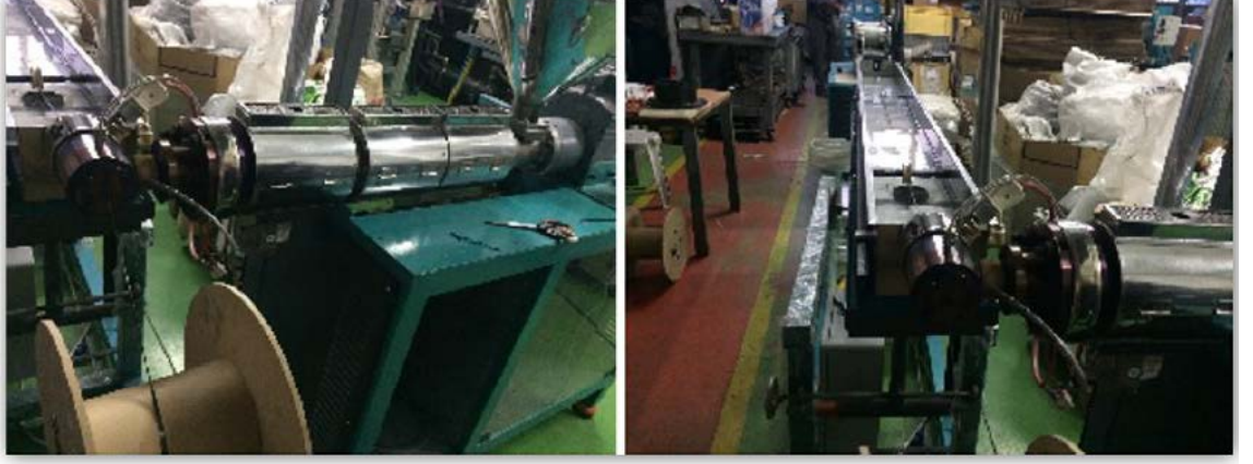
Şekil 3.2 Termoplastik monokompozit karbon fiber filament yapının üretildiği sistem ve kalıp düzeneği
