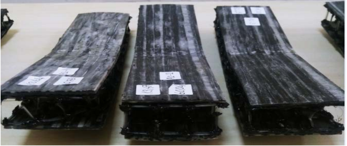
Şekil 4.35 A2 grubuna ait dinamik üç nokta eğilme test sonrası görüntüsü(A2-1,A2-2 ve A2-3)
