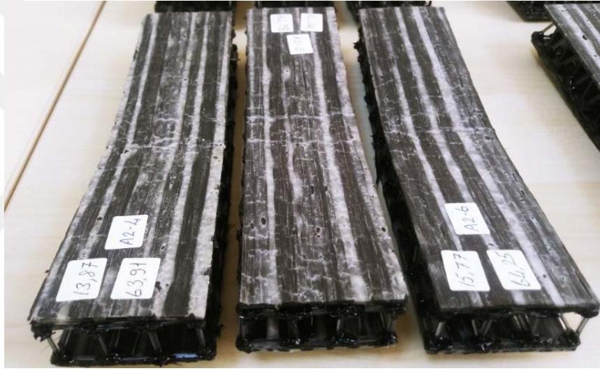
Şekil 4.58 A2 Grubuna ait statik üç nokta eğilme testi uygulanan numunelerin tamamı
