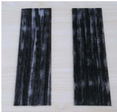
Şekil 3.5 Plakadan 50mmx200mm ölçülerinde kesilen sandviç numune plakaları Kompozit plakaların Karbon elyaf oranı %70'dir.
