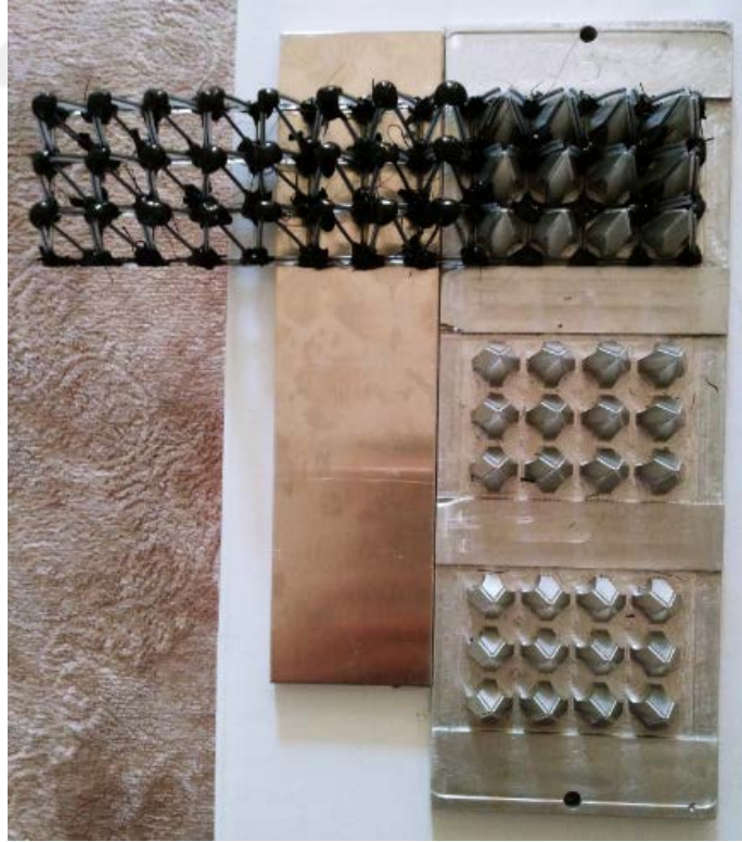
Şekil 3.33 B modeline ait kafes yapının son üretim aşaması.
