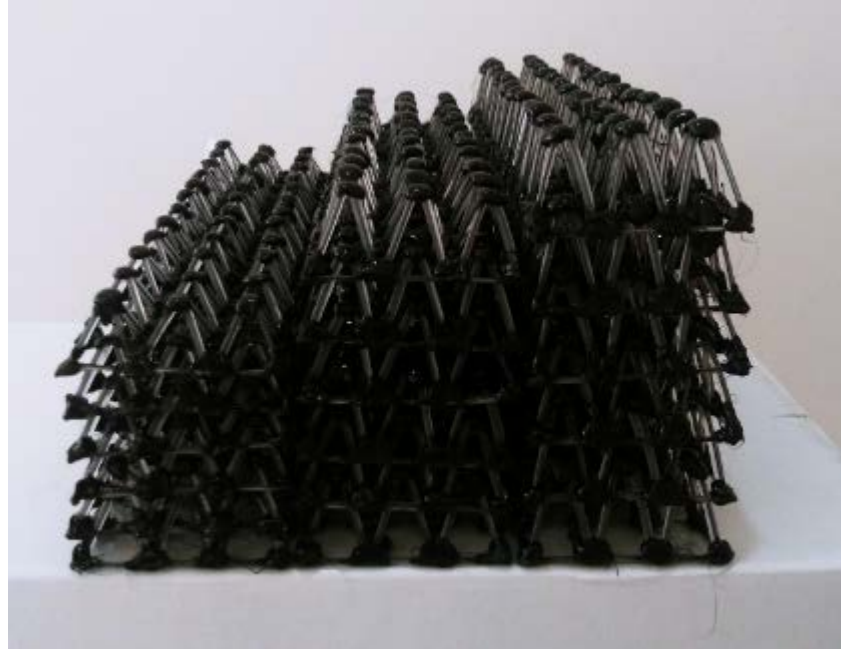
Şekil 3.35 B modeline ait üretilen numunelerin paneller yapıştırılmadan önceki halleri.
