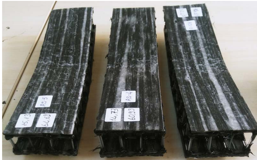
Şekil 4.59 A3 Grubuna ait statik üç nokta eğilme testi uygulanan numunelerin tamamı
