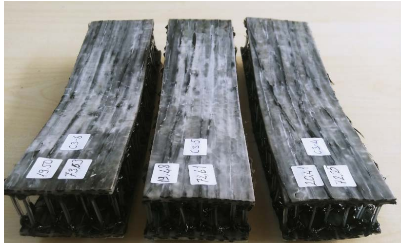
Şekil 4.69 C3 grubuna ait statik üç nokta eğilme testi uygulanan numunelerin tamamı
