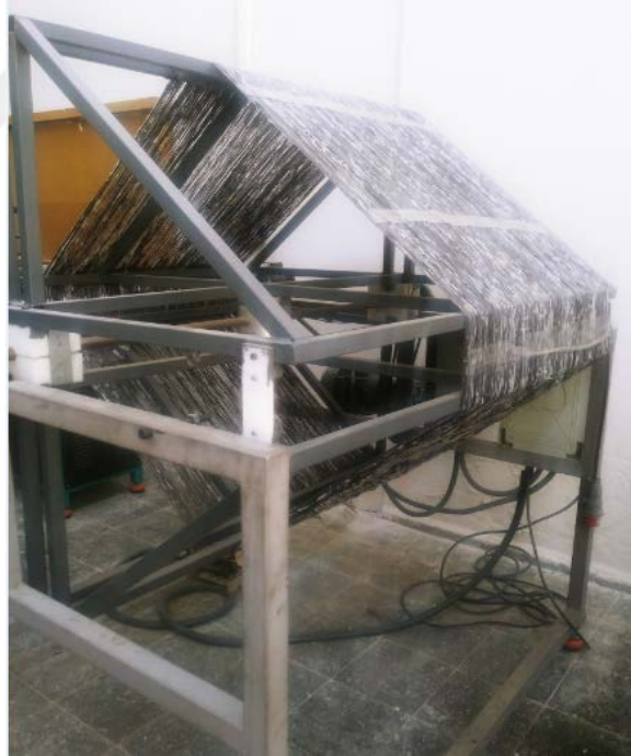
Şekil 3.3 Plaka oluşumu için hazırlanmış kompozit şeritler.
