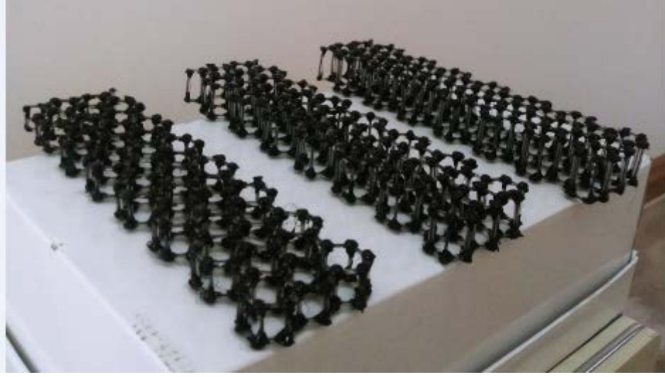
Şekil 3.43 C modeline ait üç ayrı boyda üretilmiş numune örnekleri
