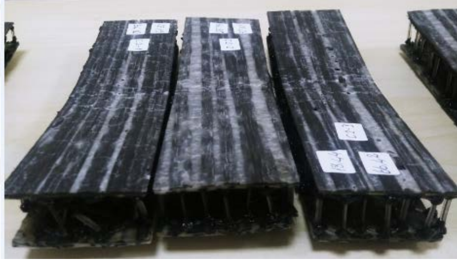
Şekil 4.45 C2 grubuna ait dinamik üç nokta eğilme test sonrası görüntüsü(C2-1,C2-2 ve C2-3)
