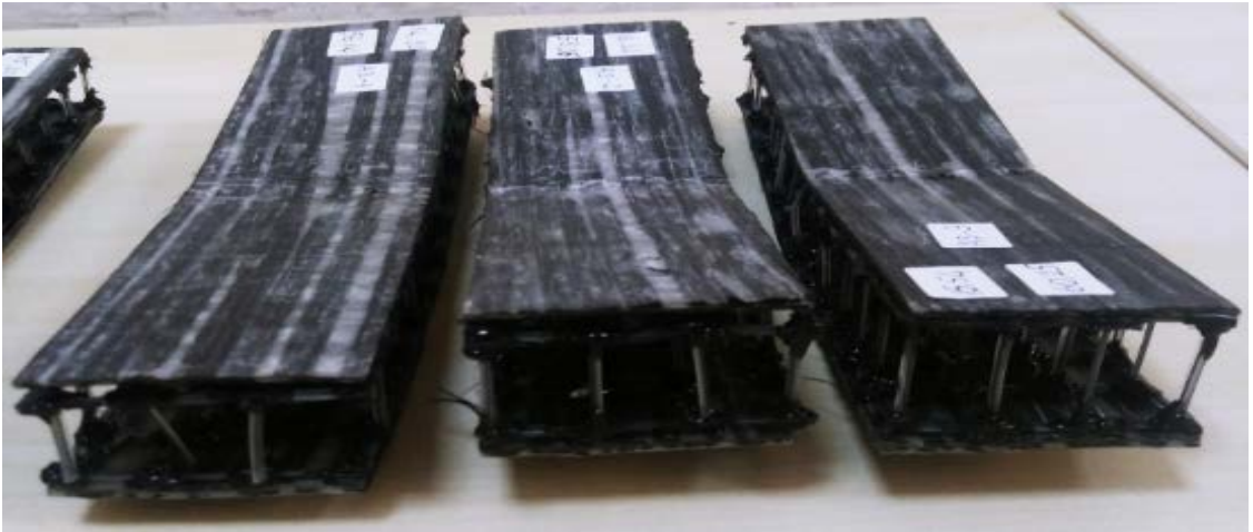
Şekil 4.36 A3 grubuna ait dinamik üç nokta eğilme test sonrası görüntüsü(A3-1,A3-2 ve A3-3)
