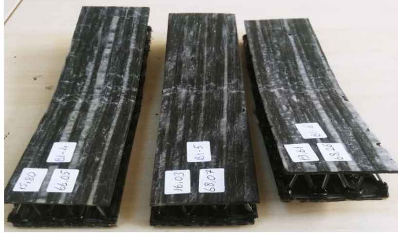
Şekil 4.62 B1 grubuna ait statik üç nokta eğilme testi uygulanan numunelerin tamamı
