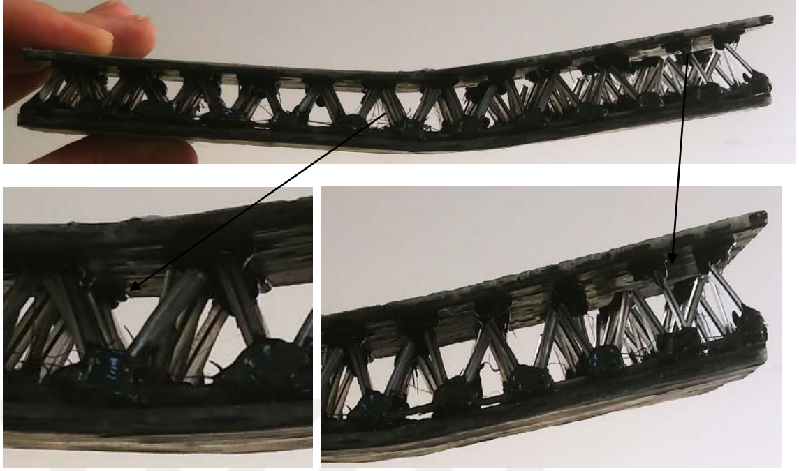
EK 76. B1-6 numunesine ait üç nokta statik test sonrası görüntüsü
