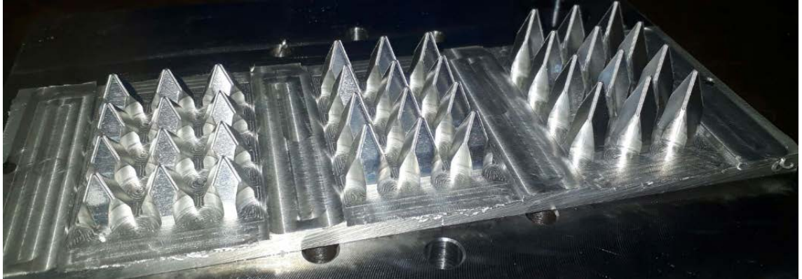
Şekil 3.30 B modeli piramit yapı kalıbı
