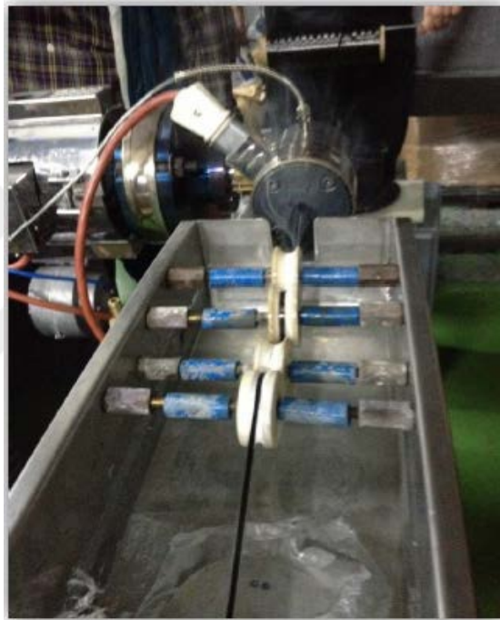
Şekil 3.6 Termoplastik monokompozit karbon fiber filament yapının kalıptan çıkışı
