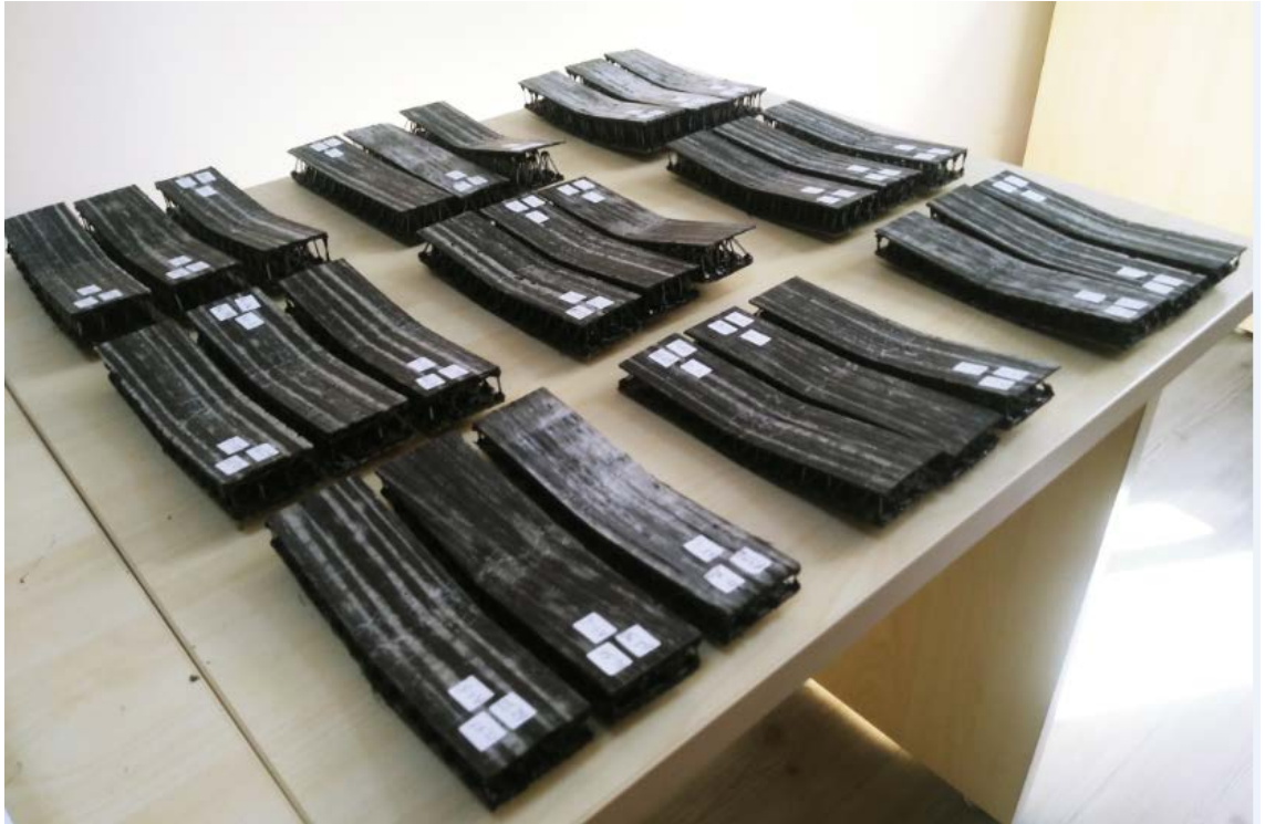
Şekil 4.56 Statik üç nokta eğilme testi uygulanan numunelerin tamamının görüntüsü
