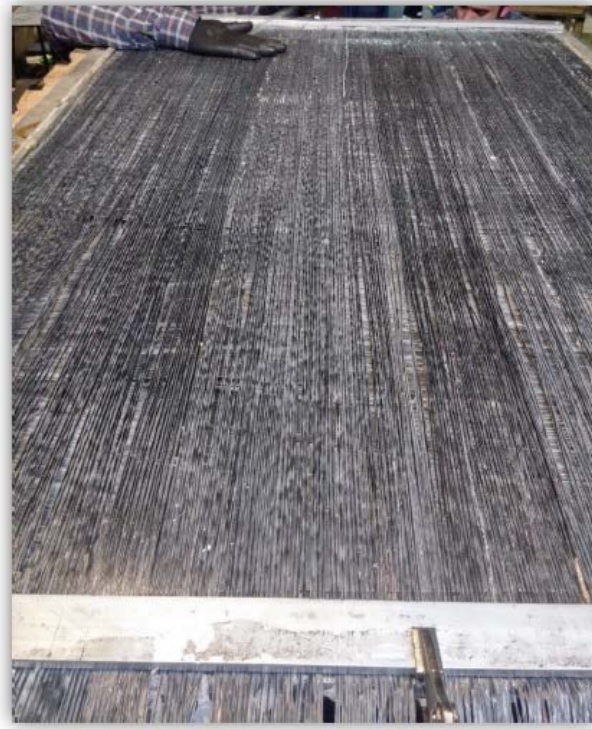
Şekil 3.4 Plaka haline getirilmiş kompozit yapının kalıptan çıkmış hali
