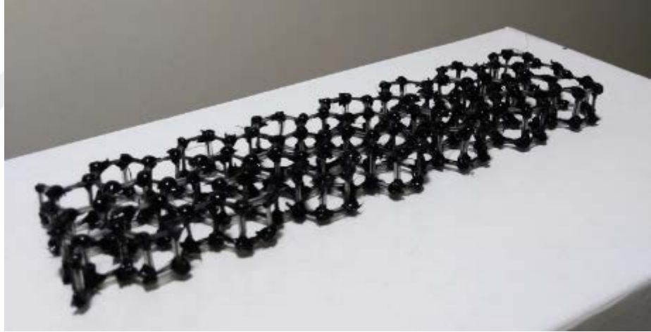
Şekil 3.42 C modeline ait kolon yerleşimi tamamlanmış kafes yapı
