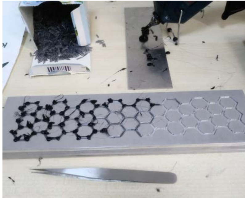
Şekil 3.22 C modeline ait petek yapının kalıp üzerine yerleştirilmesi ve üretimi işlemi
