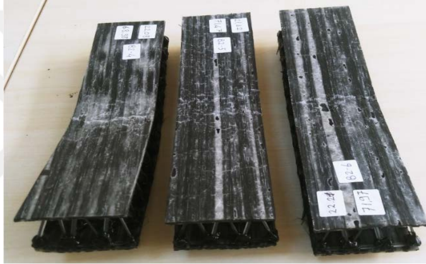
Şekil 4.63 B2 grubuna ait statik üç nokta eğilme testi uygulanan numunelerin tamamı
