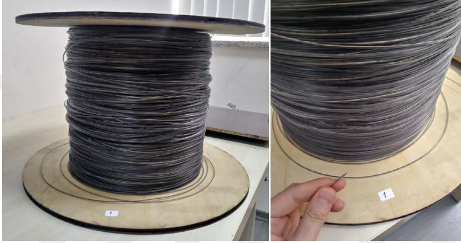
Şekil 3.8 Karbon fiber monokompozit yapının makaralara sarılmış kullanıma hazır hali
