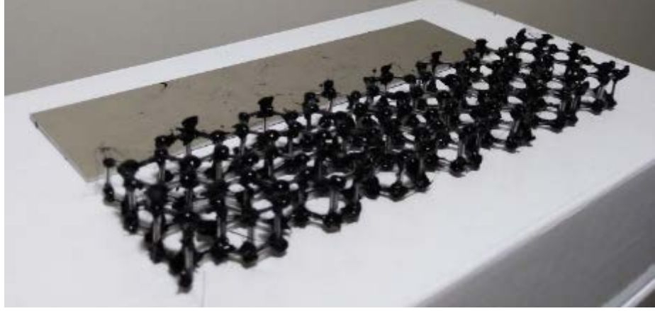
Şekil 3.41 Kolon yerleşimi tamamlanan parça
