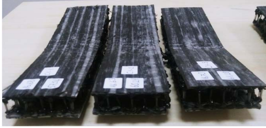
Şekil 4.44 C1 grubuna ait dinamik üç nokta eğilme test sonrası görüntüsü(C1-1,C1-2 ve C1-3)
