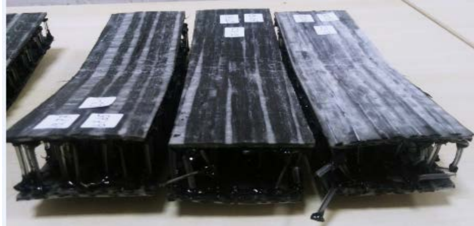
Şekil 4.46 C3 grubuna ait dinamik üç nokta eğilme test sonrası görüntüsü(C3-1,C3-2 ve C3-3)
