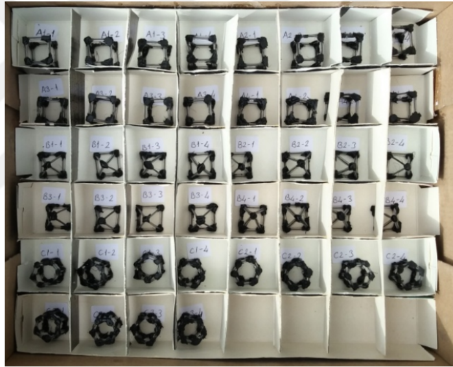
Şekil 4.8 Bası testi öncesi birim kafes yapıları
