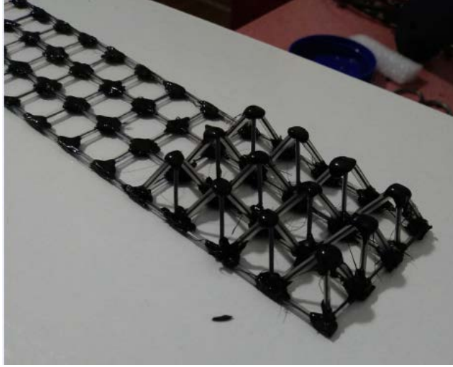
Şekil 3.32 B modeli kafes yapının ilk aşamasının kalıptan ayrılması
