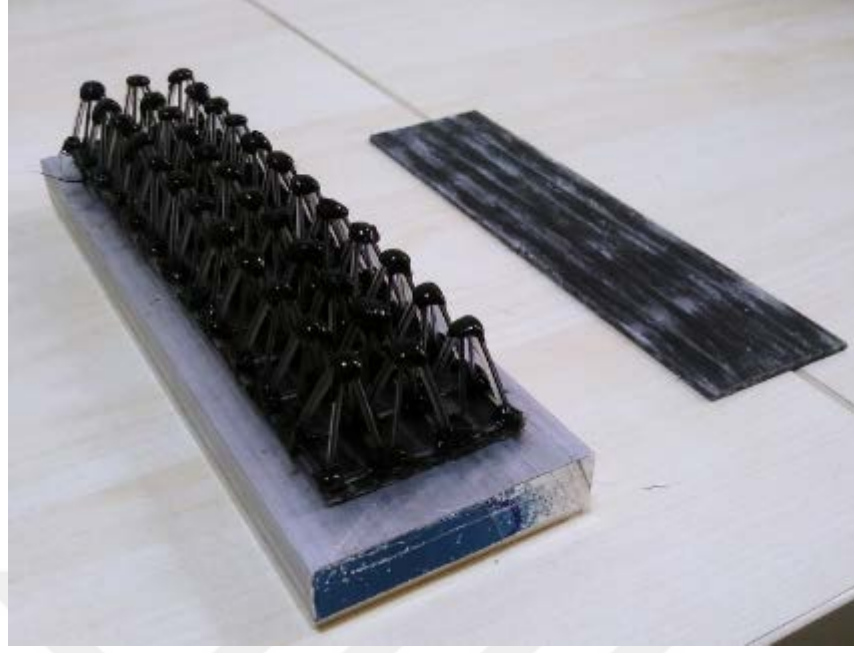
Şekil 3.47 B modeline ait sandviç yapının oluşum aşaması
