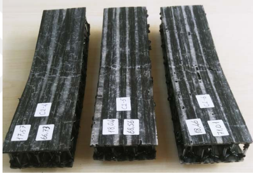
Şekil 4.68 C2 grubuna ait statik üç nokta eğilme testi uygulanan numunelerin tamamı
