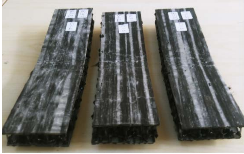
Şekil 4.67 C1 grubuna ait statik üç nokta eğilme testi uygulanan numunelerin tamamı
