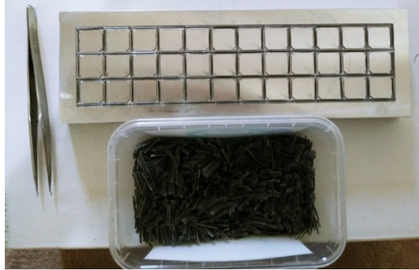
Şekil 3.19 Karbon fiber monofilament kompozitlerin kalıba yerleştirilmesi
