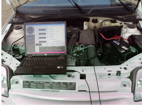
Şekil 3.23. Üzerine sıralı tip LPG sistemi monte edilen bir araçtan püskürtme stratejileri ile ilgili verilerin alınması
