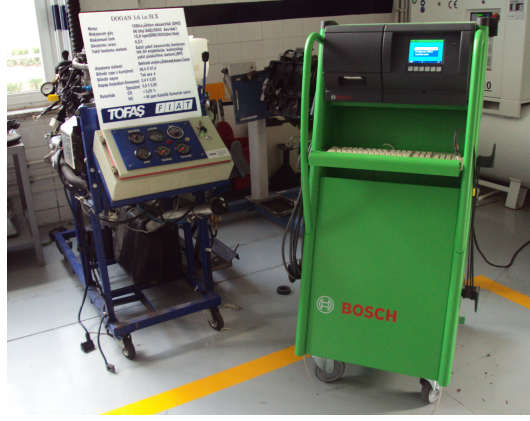
Şekil 3.10. Deneylede kullanılan BOSCH BEA–250 EU emisyon ölçüm cihazı
