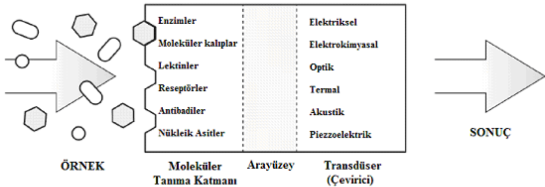
Şekil 2.1.5.1. Bir biyosensörün yapısı ve bileşenleri
