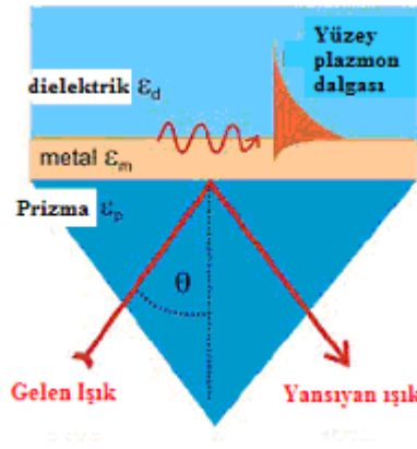
Şekil 2.2.2.2 Yüzey plazmonlarının uyarılmasında kullanılan Kretschmann konfigürasyonu
