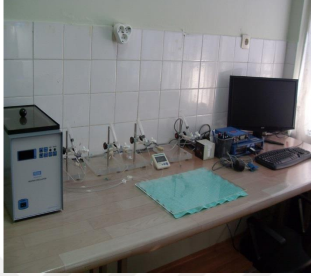
Şekil-13: Kan basıncı ve kalp atım sayısı kaydı için kullanılan MP36 sistemi ve hayvanların vücut ısını korumak için kullanılan ısıtıcı su sirkülâtörü.
