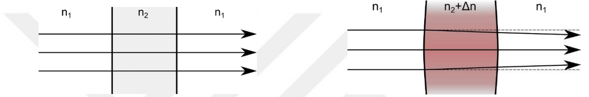
Şekil 2.15. Kristalin ısıyla yüklenmesi sonucu optik eksen sapması (COMSOL 2014)
