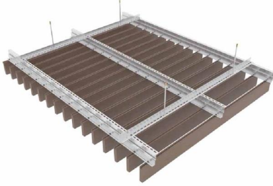
Şekil 3.10. Askı elemanlarına bağlanarak yapılan döşeme alt kaplama uygulaması (Aspen 2015).
