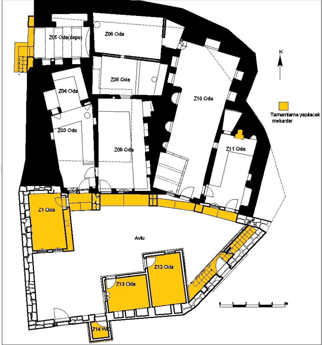
Şekil 5.3. Yapının -3.78 kotunda tamamlama yapılacak mekanlar
