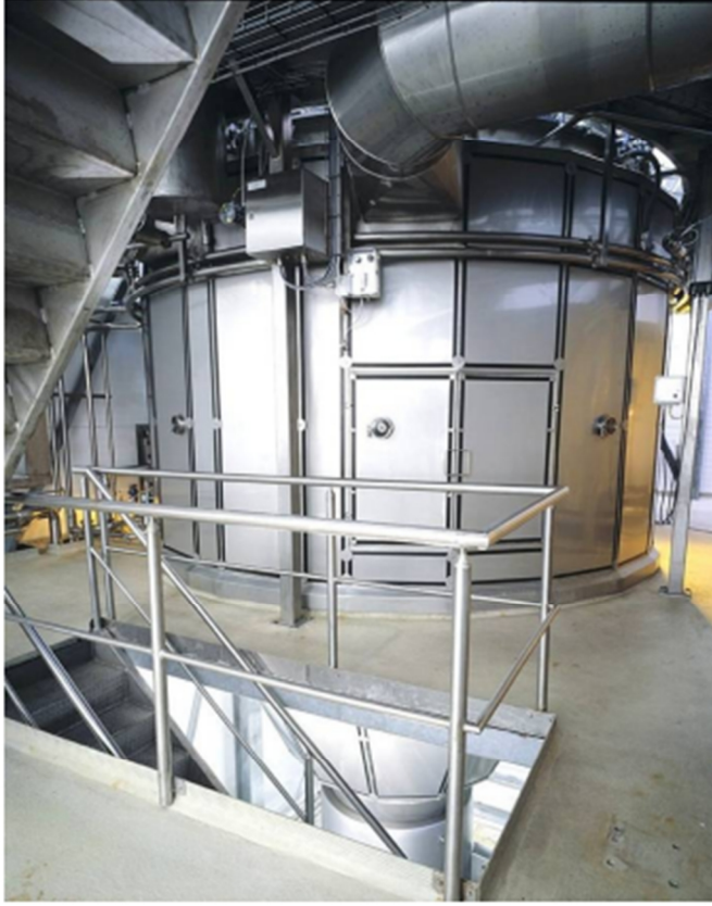
Şekil 3.2. Resimde Kurutma kulesinin bir bölümü görülmektedir. Alt katta konik kısım görülmektedir. (GEA Niro Vagn Westergaard, 2010)
