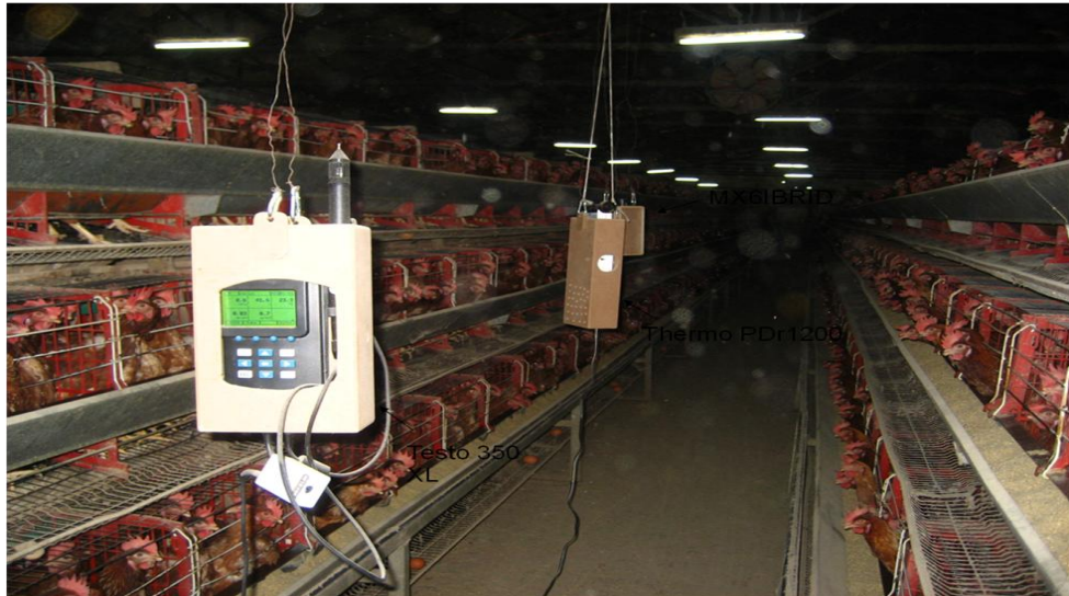
Şekil 3.1. Çok fonksiyonlu sıcaklık-nem ölçer ve sıcak telli prob
