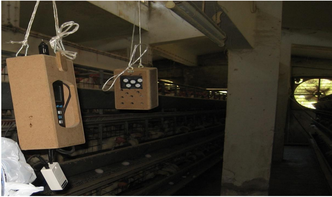
Şekil 3.4. Kümes içine yerleştirilmiş çoklu gaz ölçerin genel görünüşü
