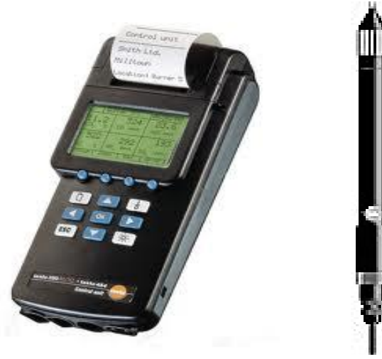
Şekil 3.1. Çok fonksiyonlu sıcaklık-nem ölçer ve sıcak telli prob
