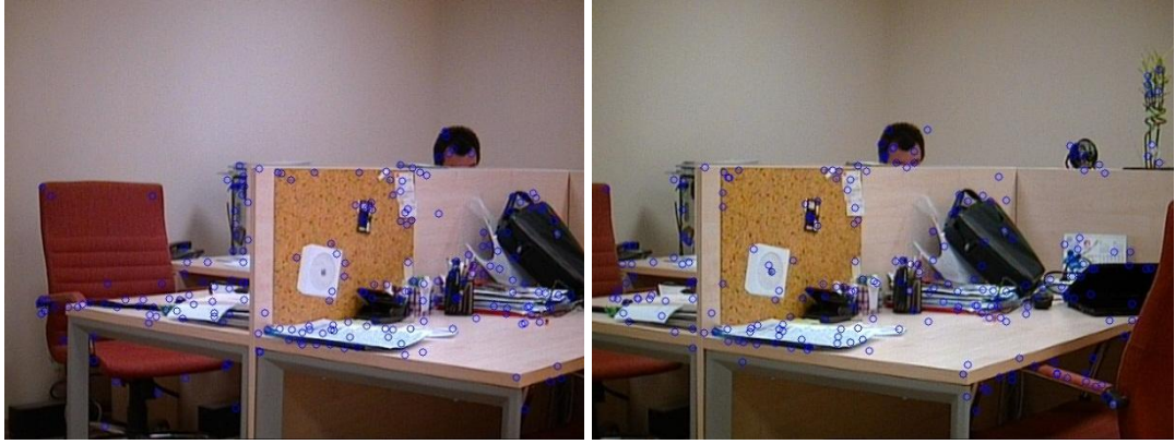
Şekil 3.3. Ardışık iki sahnedeki SURF noktaları
