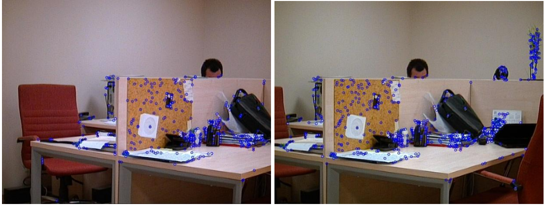
Şekil 3.4. Ardışık iki sahnedeki FAST noktaları
