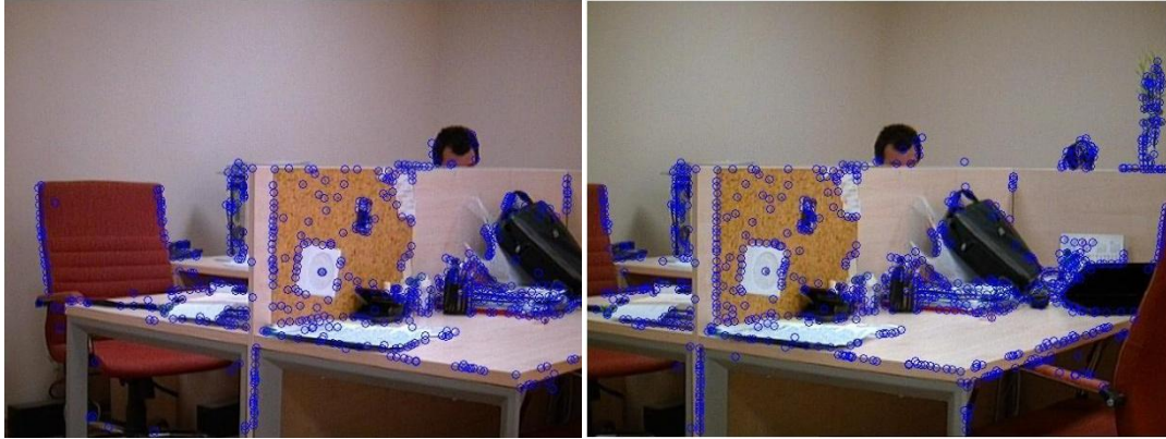
Şekil 3.2. Ardışık iki sahnedeki SIFT noktaları
