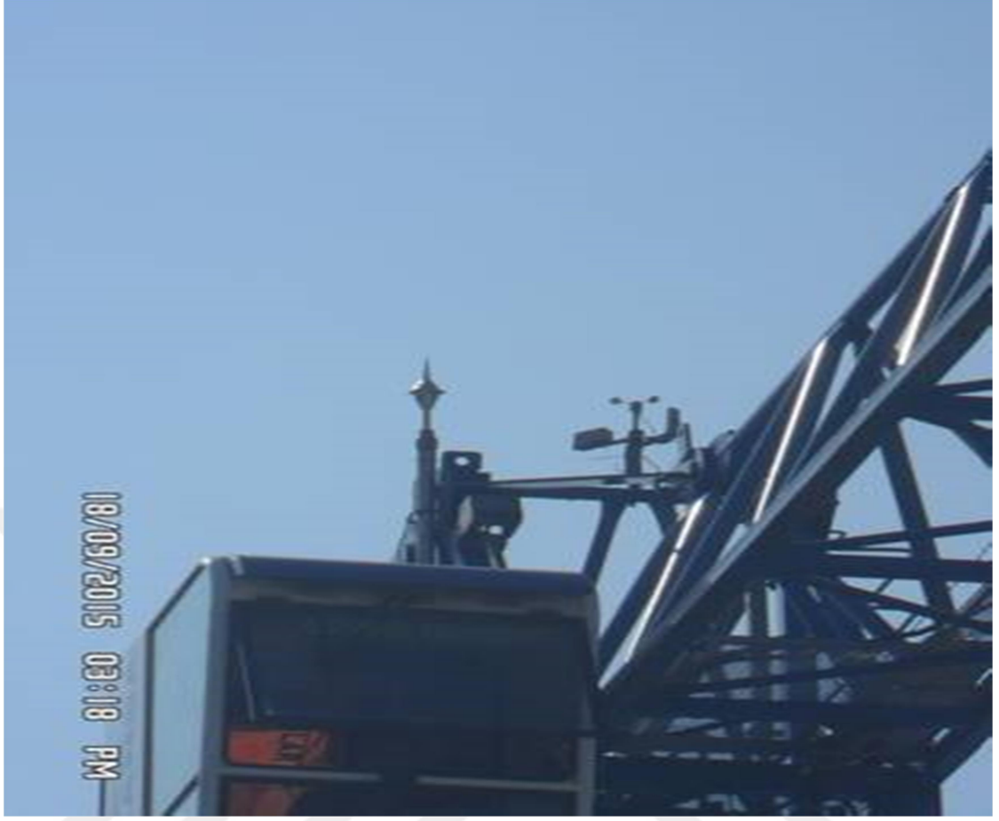
Şekil 4.12. Kule vincin tepesine kurulmuş olan paratoner tertibatı
