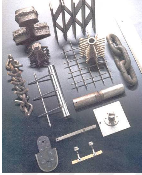
Şekil 2. 1 Elektrik direnç kaynağıyla kaynatılmış malzemeler (Anonim 2012)
