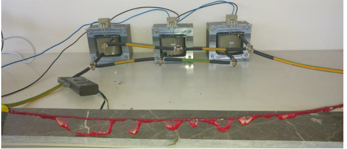
Şekil 4.14. Aşırı akım sonrası deforme olan kablo
