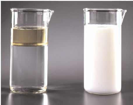
Şekil 2.3. Lesitinin yağ-su emülsiyonu oluşturma etkisi ( http:// www. hawkinswatts . com , 2011)
