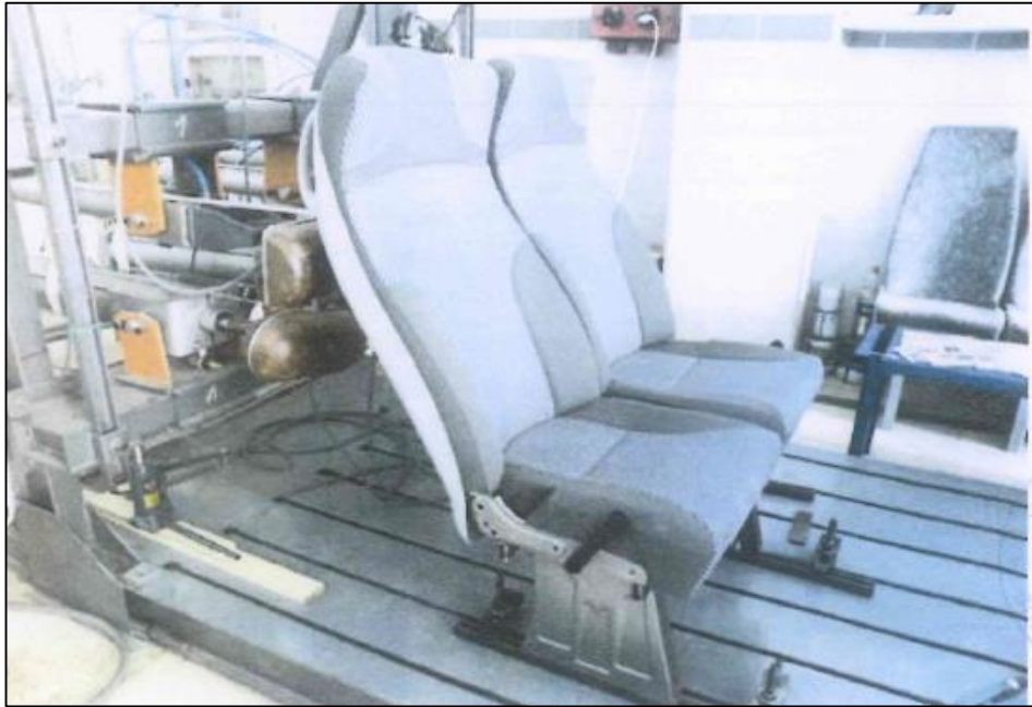
Şekil 4.37 : ECE R80 statik itme test düzeneği
