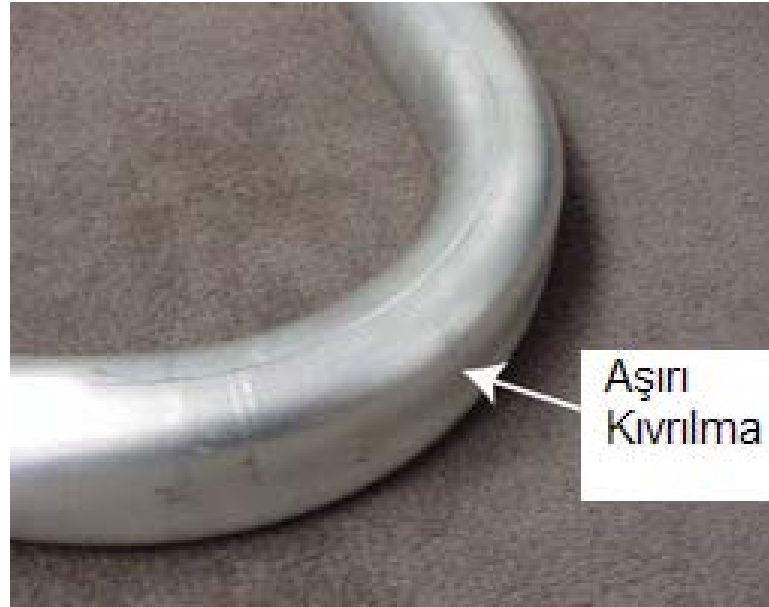
Şekil 2.53. Yamulmuş boru (Kestek 2008)
