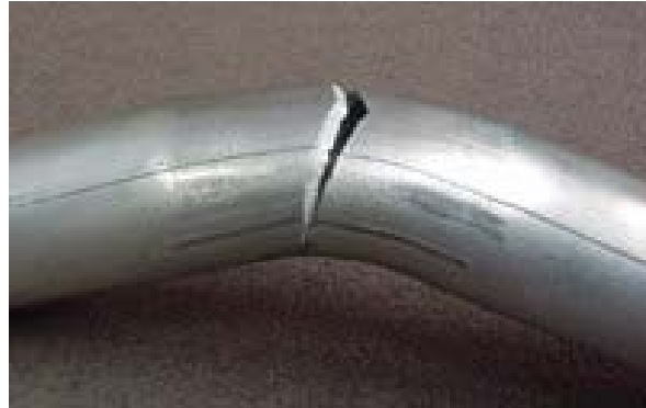
Şekil 2.50. Bükme sonrasında kırılan boru (Kestek 2008)
