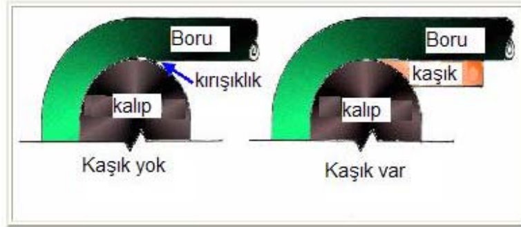
Şekil 2.51. Kaşığın kalıpla boru arasındaki boşluğu doldurması
