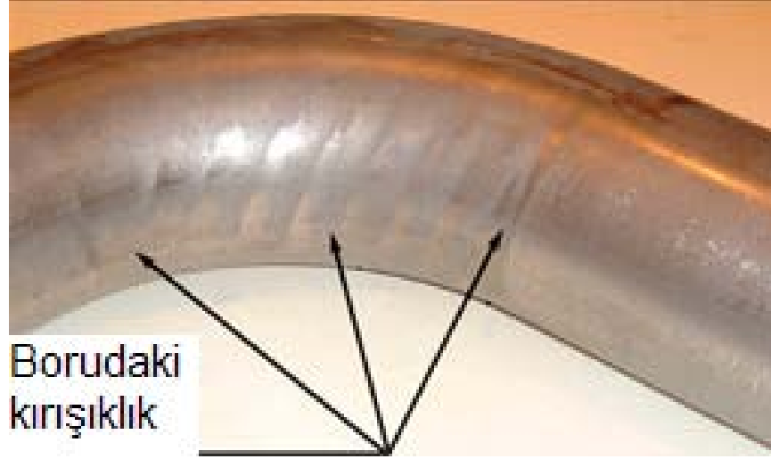
Şekil 2.52. Kırışmış boru (Kestek 2008)
