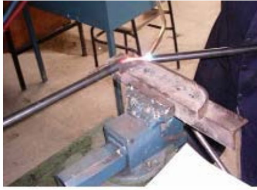
Şekil 2.16. Kalıpta bükme (Megep 2006)
