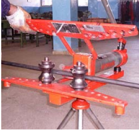
Şekil 2.20. Paçanın makineye bağlanması (Megep 2006)
