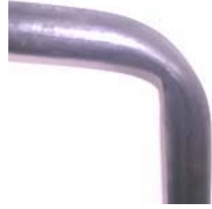
Şekil 2.15. Hatalı büküm (Megep 2006)
