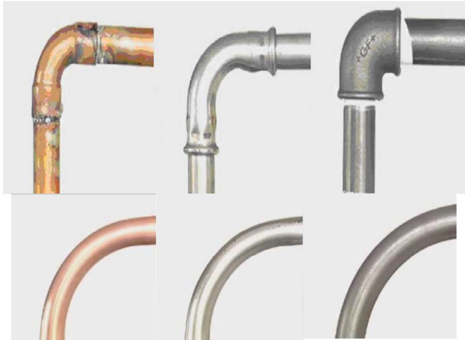
Şekil 2.31. Tesisatlarda kullanılan boru bükme uygulamaları (Karataş. 2010)
