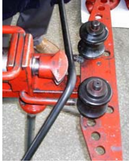
Şekil 2.22. Parçanın makineden çıkartılması (Megep 2006)
