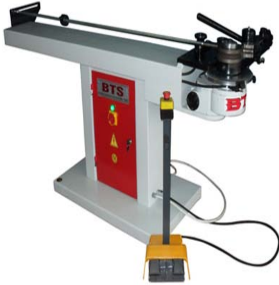
Şekil 2.33. Manuel Yarı Otomatik Boru- Profil Bükme Makinası (www.btsmakina.com)
