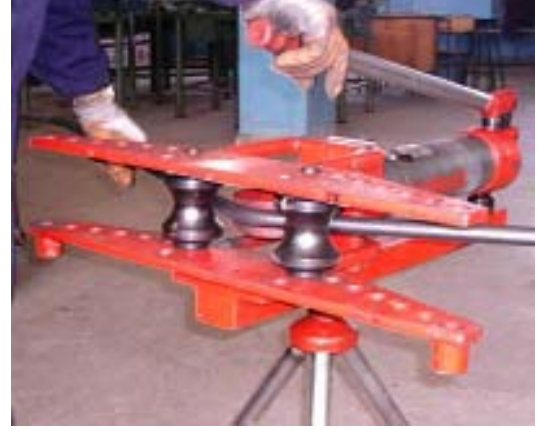
Şekil 2.21. Parçayı makinede bükme (Megep 2006)
