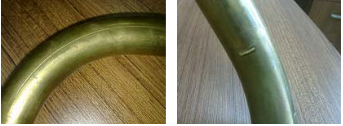
Şekil 2.54. Yüzey pürüzlülüğü bozulmuş boru
