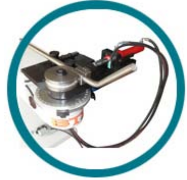
Şekil 2.35. Kalıba bağlı hidrolik sistem (BTS Makine)
