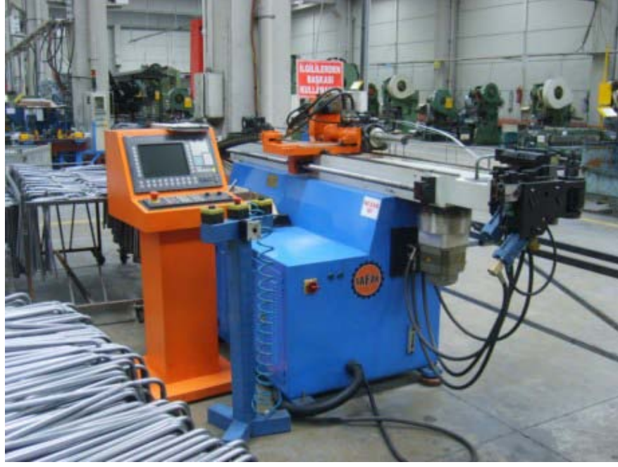
Şekil 2.23. CNC boru bükme makinesi (www.ozismakina.com.tr)
