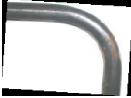
Şekil 2.14. Doğru büküm (Megep 2006)
