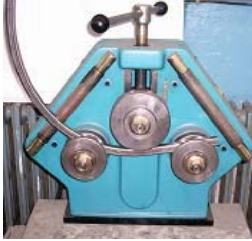
Şekil 2.29. Parçanın bükülmüş şekli (Megep 2006)
