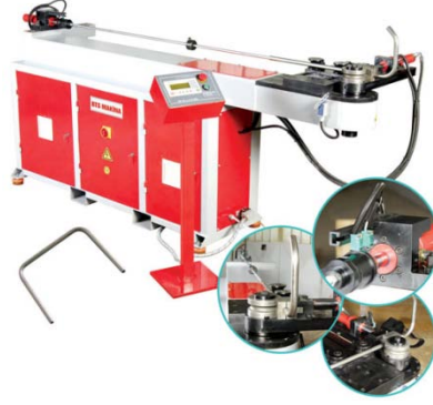
Şekil 2.36. PLC Kontrol Dijital Dereceli Boru- Profil Bükme Makinası (www.btsmakina.com)
