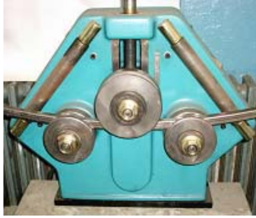
Şekil 2.28. Parçanın bükmeye başlaması (Megep 2006)
