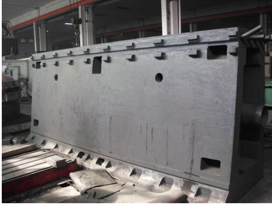
Şekil 5.62.Dökülen ilk parça (Konsol, Yan duvarlar)
