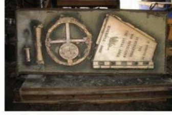
Soğuma sonrasında üst derece çıkartılarak Döküm üzerinde kalan yolluk ve çıkıcı kısımlar kesilir.
