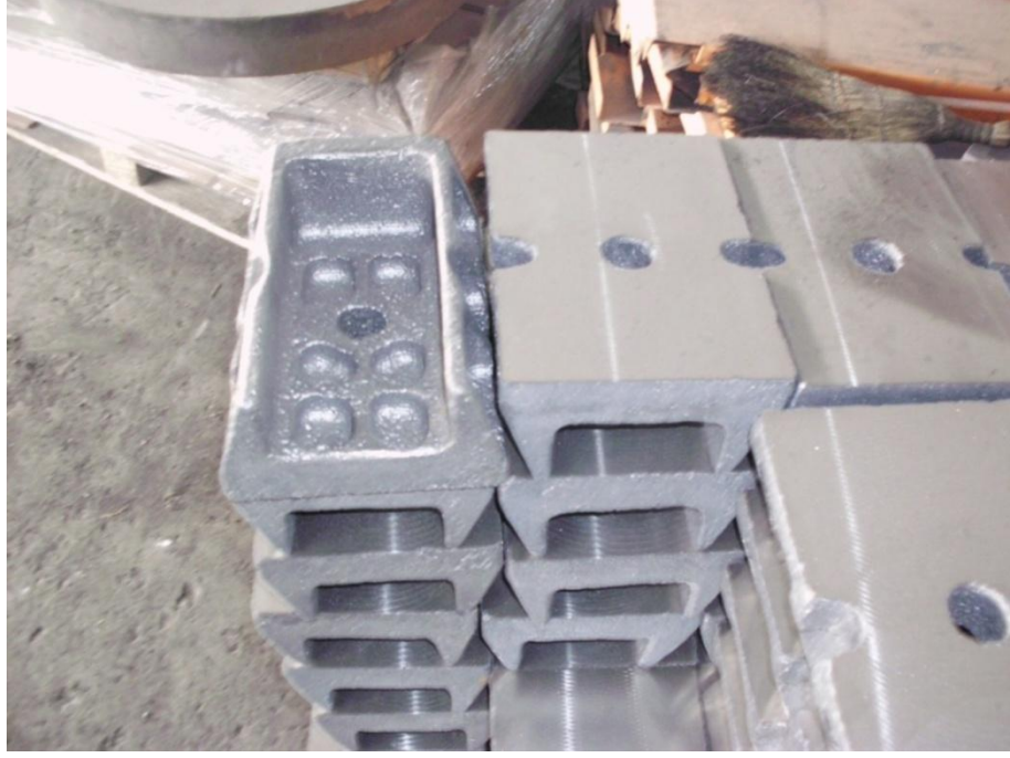
Şekil 5.66.Dökülen yan duvar ayakları
