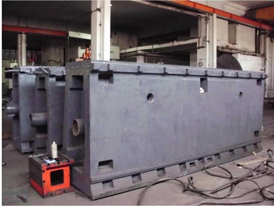
Şekil 5.65.Dökülmüş yan duvarlar(3'lü grup)
