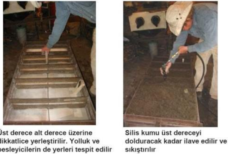
Şekil 5.55. Kalıplama adımları (Çolak, 2012)
