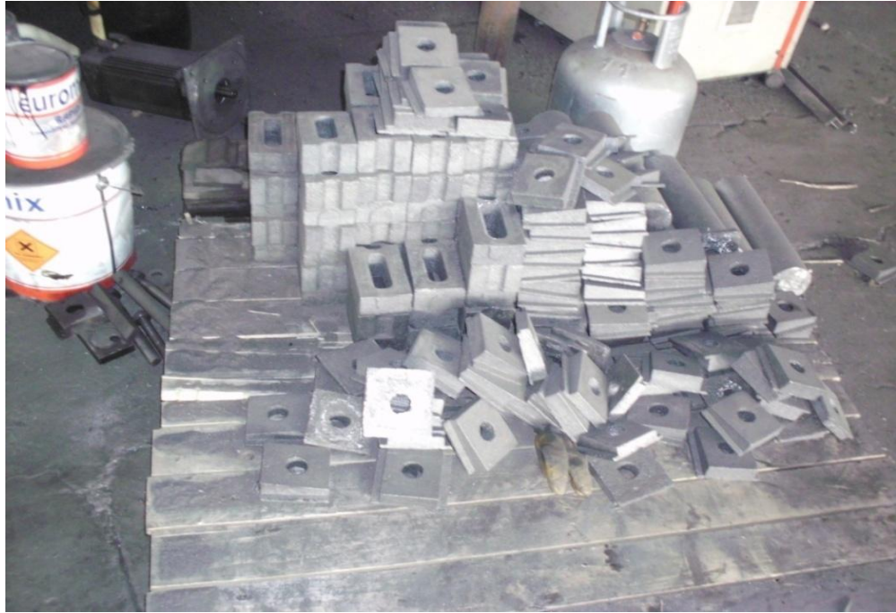
Şekil 5.67.Dökülmüş olan ayak parçaları
