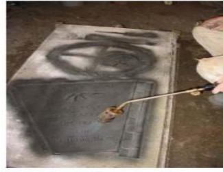
Kalıp boşluğuna grafit püskürtülerek ısıtılır. Böylece kalıp boşluğu sertleştirilmiş olur
