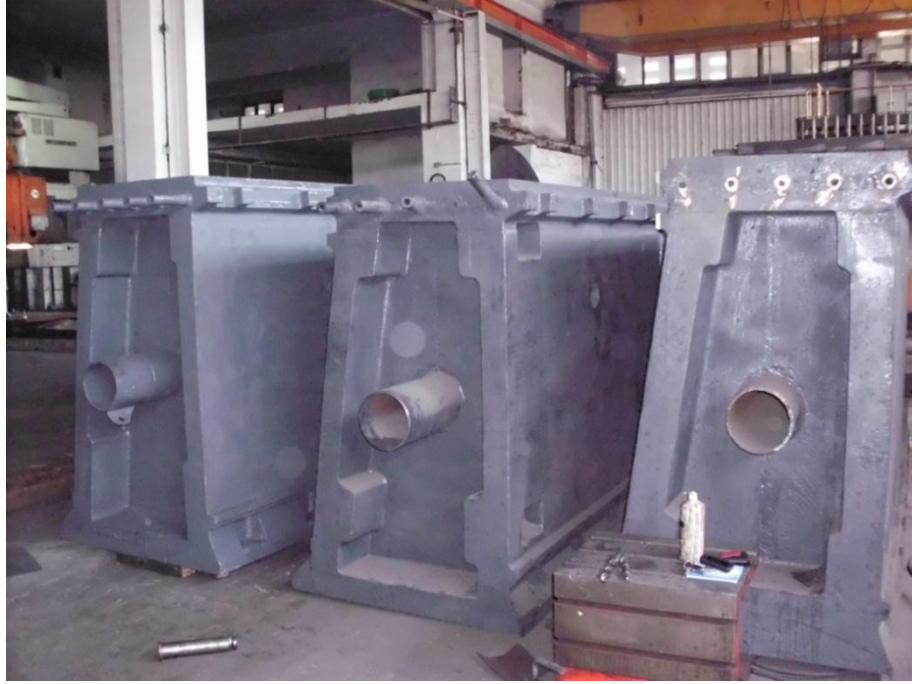
Şekil 5.63.Dökülmüş yan duvarlar
