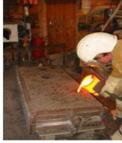
Eritilmiş metal üst derece üzerinde var olan yolluk içerisine dökülür
