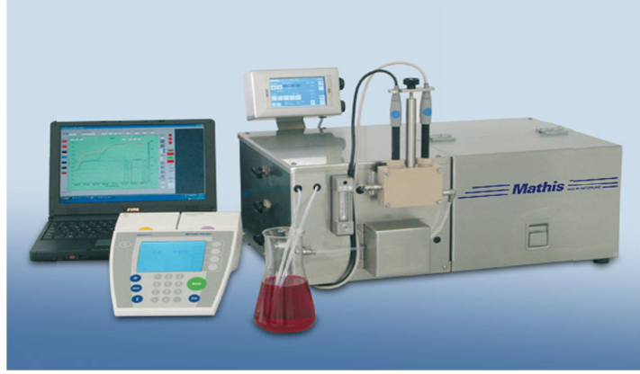
Şekil 3.1. Gerçek Zamanlı Spektrofotometrik Analiz Sistemi ( http://www.mathisag.com , 2010)
