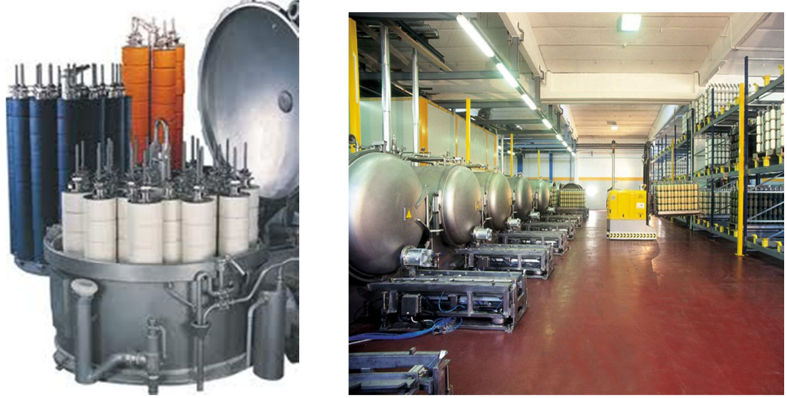
Şekil 2.8. İplik bobini boyama makinesi ( http://www.devtaraindustries.in , 2012) ve bir iplik boyahanesi ( http://www.nosedal893.it , 2012)
