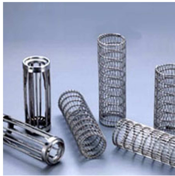
Şekil 2.9. Boyama Kovanları a)Metal Kovanlar( http://www.supplierlist.com ,2012) b)Plastik Kovanlar ( http://www.plastic-bobbins.com , 2012)
