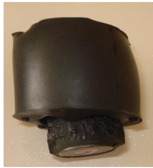
Şekil 4.6 Yapışma Testinden Çıkmış Numune
