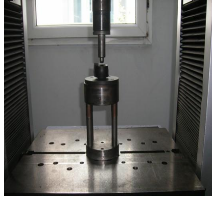
Şekil 3.18 Yapışma Testi Düzeneği
