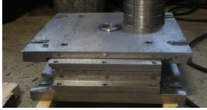
Şekil 3.3 Numuneler için Vulkanizasyon Kalıbı
