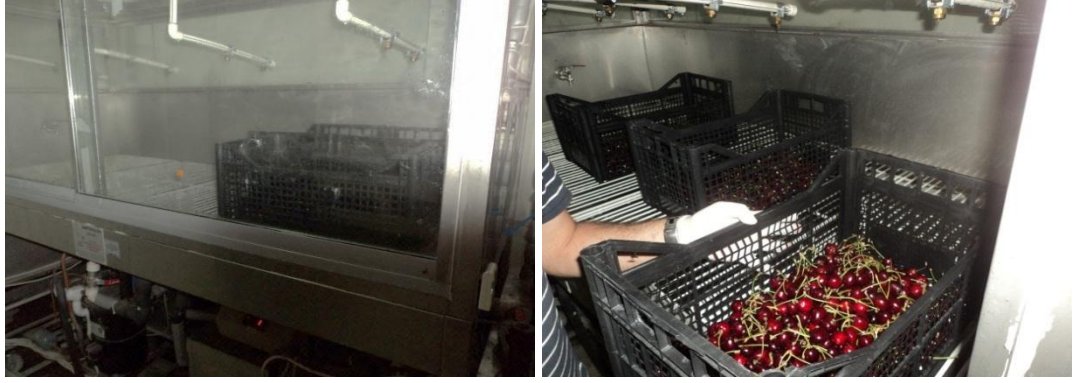
Şekil 3.3. Deneme kapsamında kullanılan su ile ön soğutma prototipinin görünüşü
