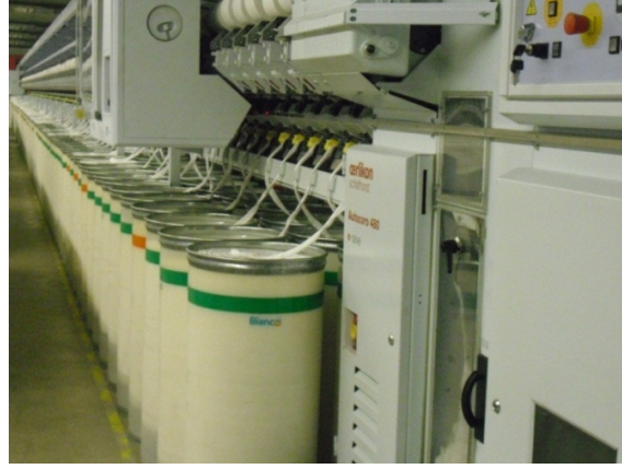
Şekil 3.2. Deneysel çalışmanın yapıldığı Schlafhorst Autocoro 480 open-end rotor iplik eğirme makinesinden bir görüntü
