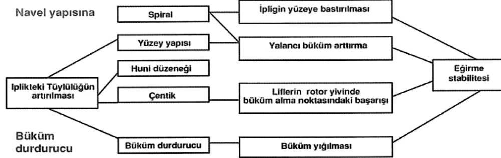
Şekil 2.26. Düze ve büküm durdurucunun iplik görünümü ve eğirme stabilitesine etki eden hususları (Yapıcılar 2005)
