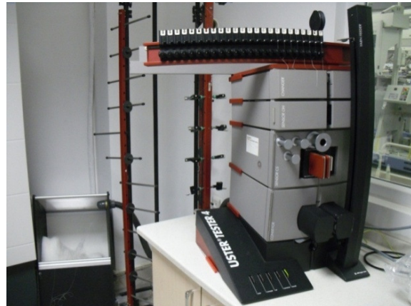
Şekil 3.5. Deneysel çalışmada kullanılan Uster Tester 4-SX iplik düzgünsüzlük ve tüylülük test cihazı
