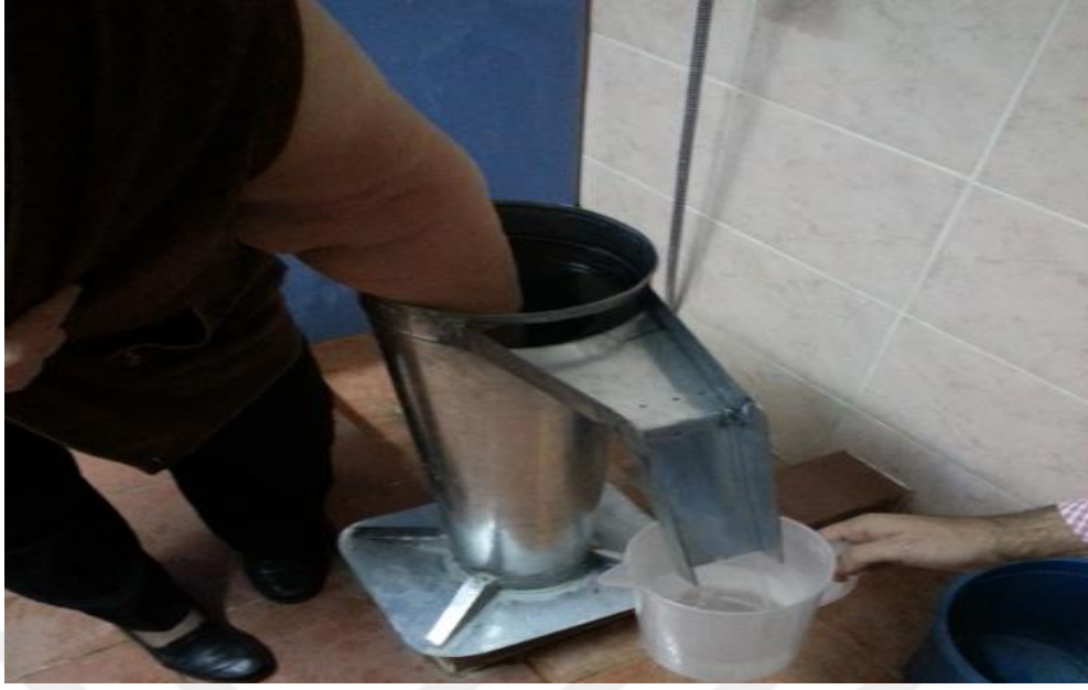
Şekil-6: 2. 10 cm düzeyinde hacim ölçümü
