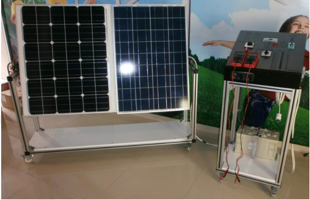
Şekil 3.12. Fotovoltaiik deney sistemi ve elektriksel ölçüm sistemi genel görünüşü
