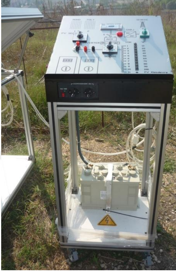
Şekil 3.14. Elektriksel ölçüm sistemi
