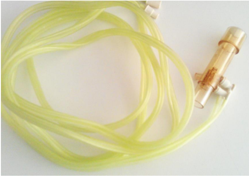
Resim-2: Akış sensörü ve örnekleme hattı.
