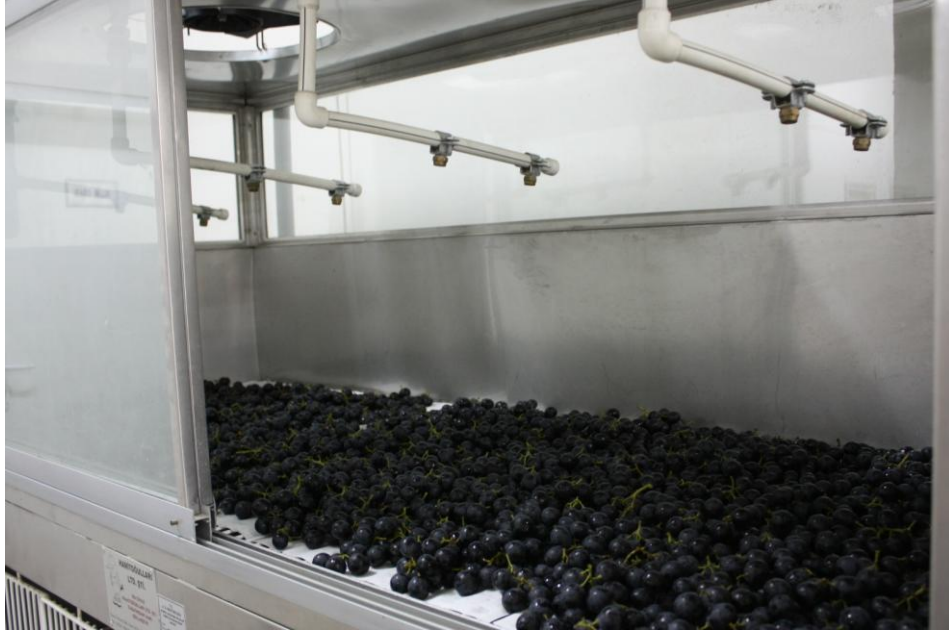
Şekil 3.2.1.1. Ön uygulaması tamamlanan çiltimlerin kurutma kabinde kurutulması işlemi
